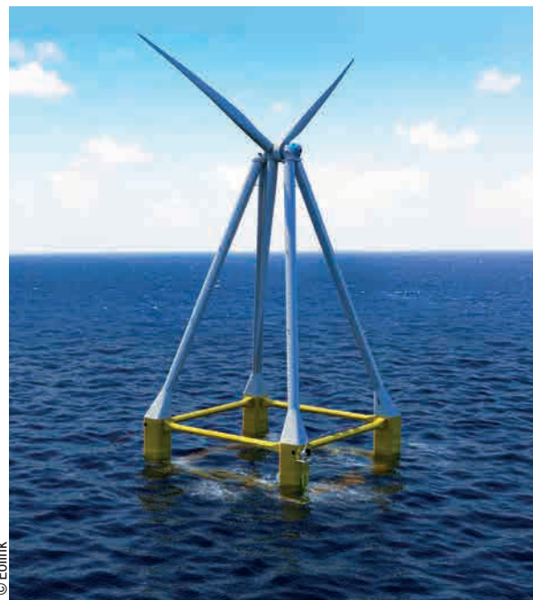
Une fois achevée, la structure flottante culminera à 150 m de hauteur.
