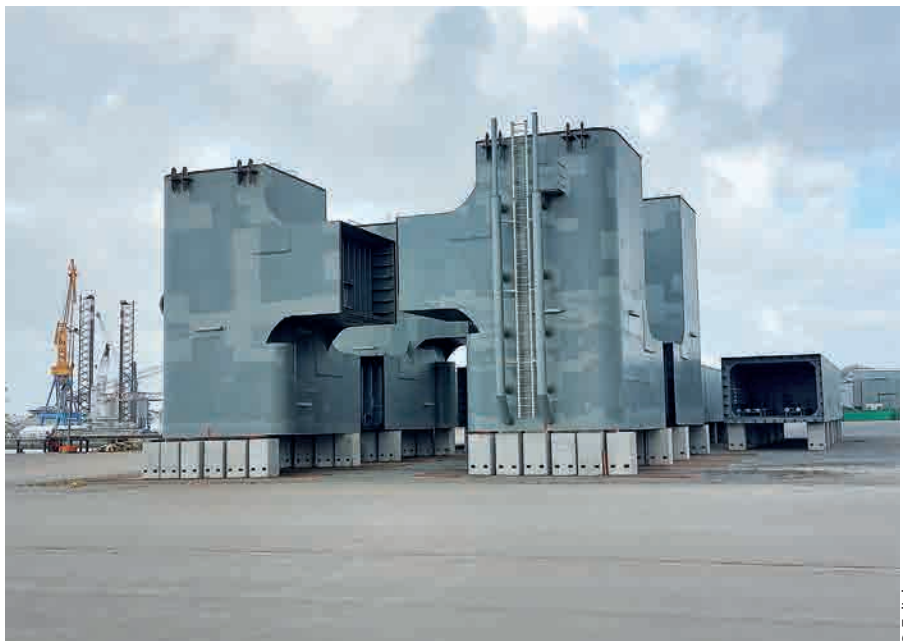
Le flotteur de l'éolienne imaginée par Eolink est composé de blocs d'acier préfabriqués.
